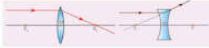
படம் 2.4 ஒளியியல் அச்சுக்கு இணையாக ஒளிக்கதிர் செல்லுதல்
